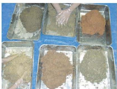
写真 4-3⑥ 適度に水加えながら手で捏ねていく (筆者撮影)
