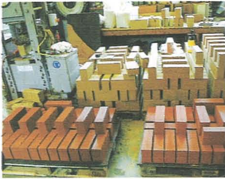
図 3-1-4⑤ 圧縮レンガブロック（手前が赤土、奥は黄土を使用）
