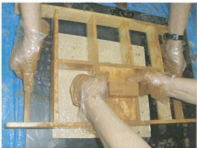
写真 4-3⑨ 上から蓋のようなもので押さえつけ型枠を引き上げる
