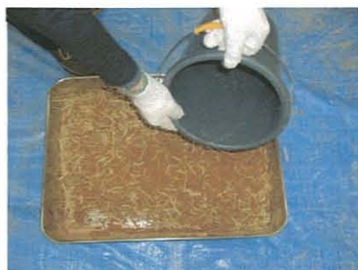
写真 4-3④ 水を少量ずつ加える
