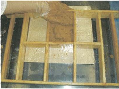
写真 4-3⑦ ならした土を型枠に入れ込む
